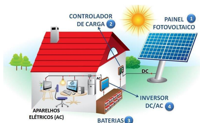
Fig.1 – Sistema Fotovoltaico Isolado (Off-grid).
